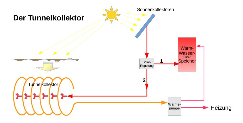
Die **Sonnenkollektoren** versorgen zuerst den Warmwasser-Speicher, danach wird die Erde im und um den Tunnelkollektor erwärmt.
